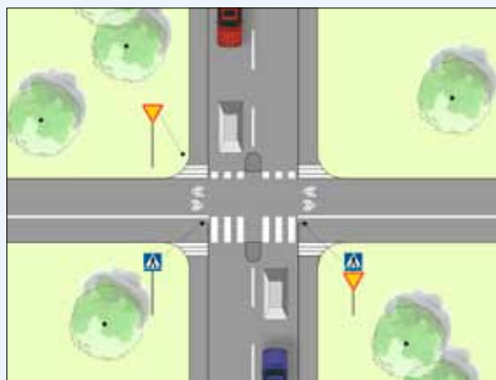
Principritning 2. Pendlingsstråk – hastighetsdämpning (lämplig på gator med busstrafik)
