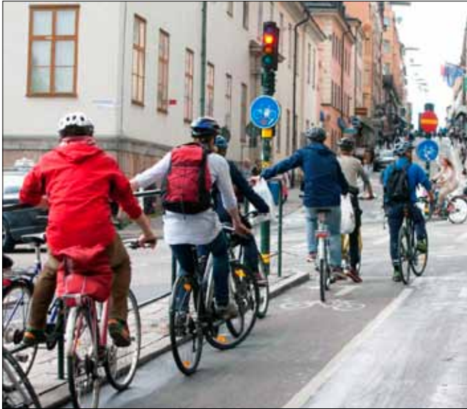
Cyklister som väntar på grönt ljus i korsningen vid Södermalmstorg. Räcket till vänster gör att cyklisten inte behöver kliva av cykeln utan kan sitta kvar på den och enkelt fortsätta sin färd när trafiksignalen slår om.
