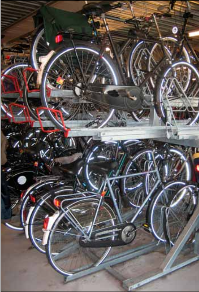
Ett exempel från ett cykelparkerings-garage i Holland. Den visar en yteffektiv cykelparkering i två plan med tak och låsanordningar.
